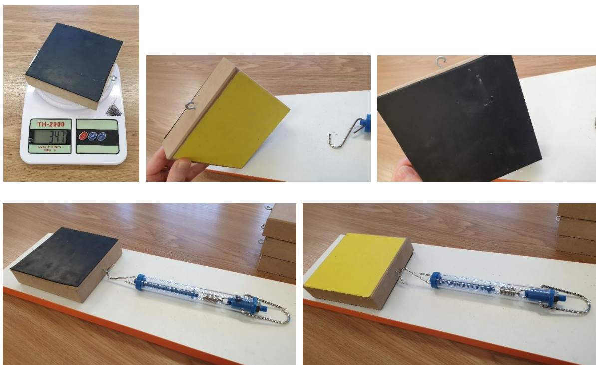
Rys. 4. Zdjęcie zestawu stosowanego do pomiaru zależności siły tarcia statycznego i kinetycznego od rodzaju powierzchni styku ciał (a – zasoby z zestawu w opcji 1, b – zasoby z zestawu w opcji 2).
