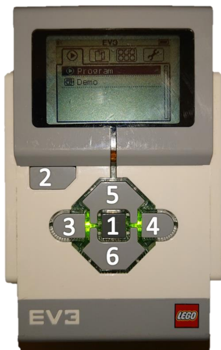
rys. 9 - uruchomiony system operacyjny kostki „Brick” wraz z opisem klawiszy
