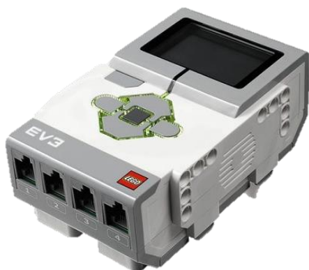
rys. 3 - kostka EV3 - mikrokontroler
