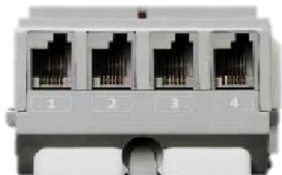
rys. 7 - gniazda portów kostki „Brick”, do których należy podłączyć czujniki
