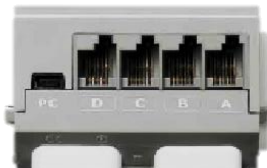
rys. 8 - gniazda portów kostki „Brick”, do których należy podłączyć silniki
